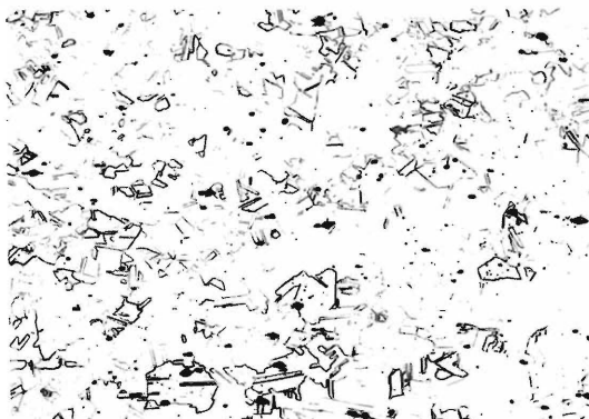
Fig. 3 - Microstruttura del nastro rilevata nella zona a maggior spessore - Ingr. X 100 - (Attacco: H 2 O 2 + NH 4 OH).
